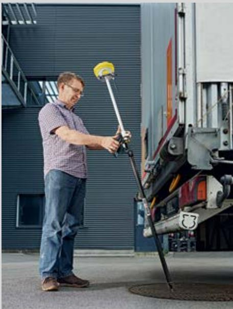
Wenn Sie sicher sein möchten, dass der Lotstock vertikal ausgerichtet ist, warnt Sie der Zenith35 Pro TAG sobald Sie sich außerhalb der definierten Zentriergenauigkeit befinden, wobei die Messqualität dokumentiert wird.
